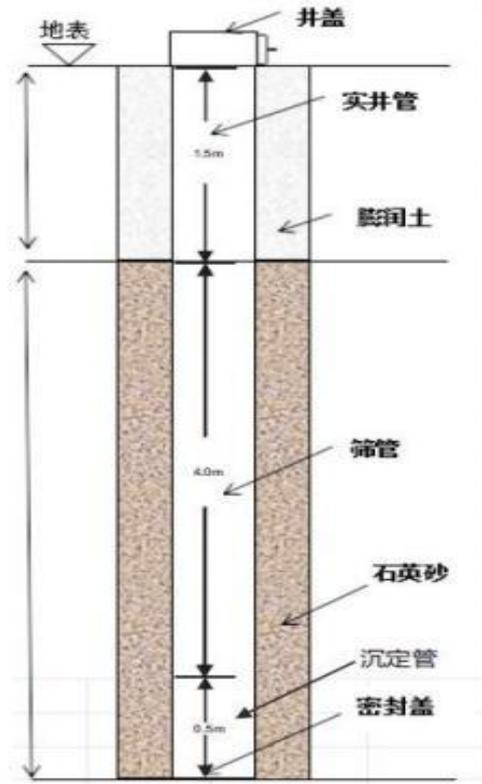
图 7.2-1 地下水监测井结构示意图
