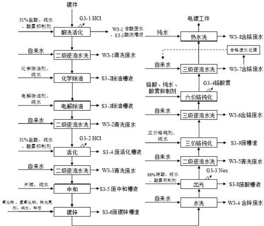
图 4.1-2 碱性镀锌生产工艺流程图
