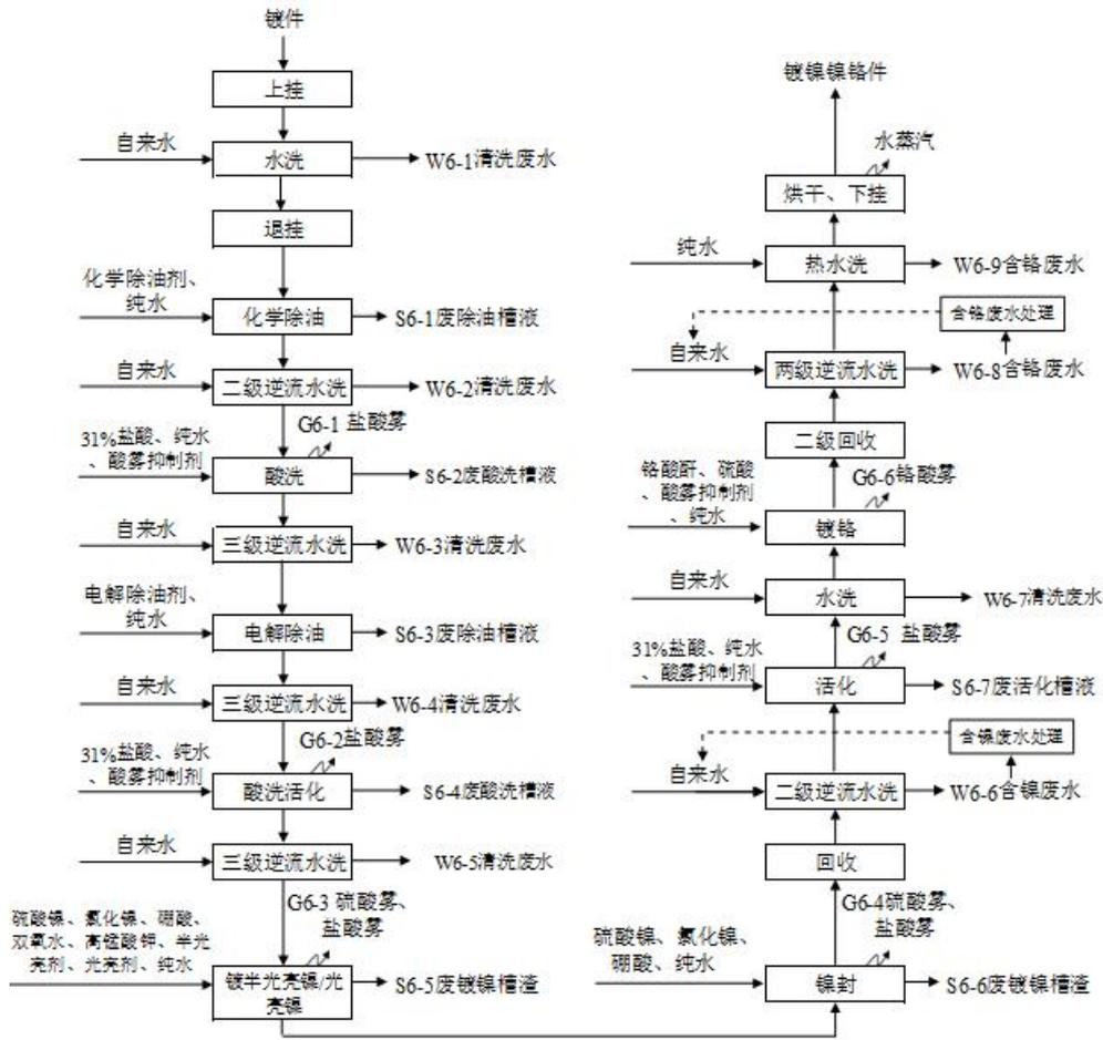
图4.1-4 镀镍镍铬生产工艺流程图
