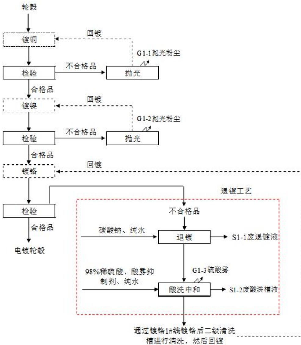
图4.1-1 镀铜镍铬总体工艺流程图
